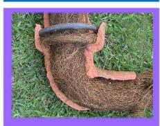
Корни деревьев часто являются причиной засорения внутренних канализационных трубопроводов. Корни могут проникать в трубы через трещины, дефекты и соединительные швы.
